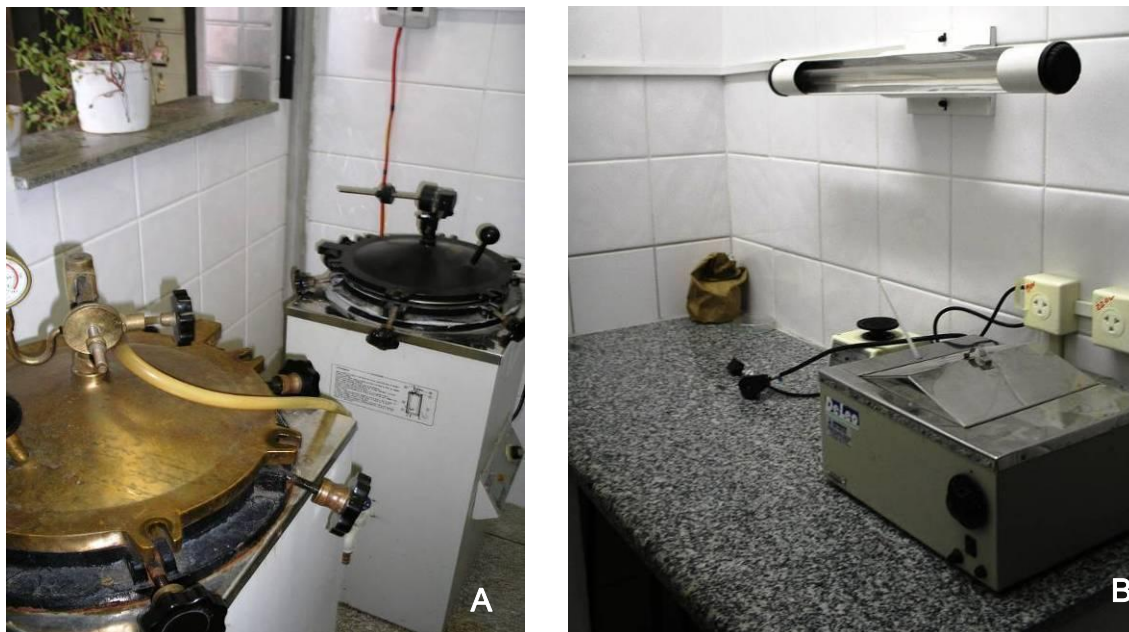
Figura 35 (A e B) – A - Autoclaves, liberação de calor; B - Sala com luz ultravioleta.
